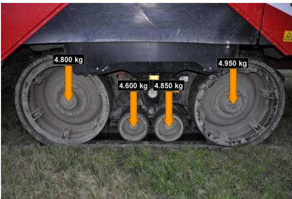
Foto 1. Het gewicht op de rupsen van de Grimme Maxtron was zeer gelijkmatig verdeeld (2010). Van voor naar achter rustte er op de loopwielen respectievelijk 25%, 24%, 25% en 26% van het totale gewicht op de rups. In combinatie met het grote contactoppervlak van de rupsen resulteert dit in een snellere afbouw van de bodemdruk dan onder de banden van bunkerrooiers.
