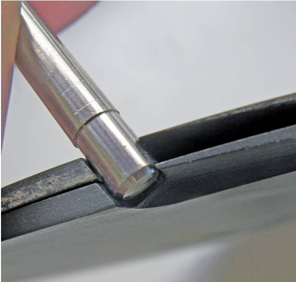
Foto 1. De paspen van Accord Monopill illustreert het kleine verschil in celdiameter tussen een afgekeurde (bovenste) en goedgekeurde (onderste) zaaischijf (2010). Een zaaischijf wordt afgekeurd als het smalle gedeelte van de paspen door één of meer cellen past.
